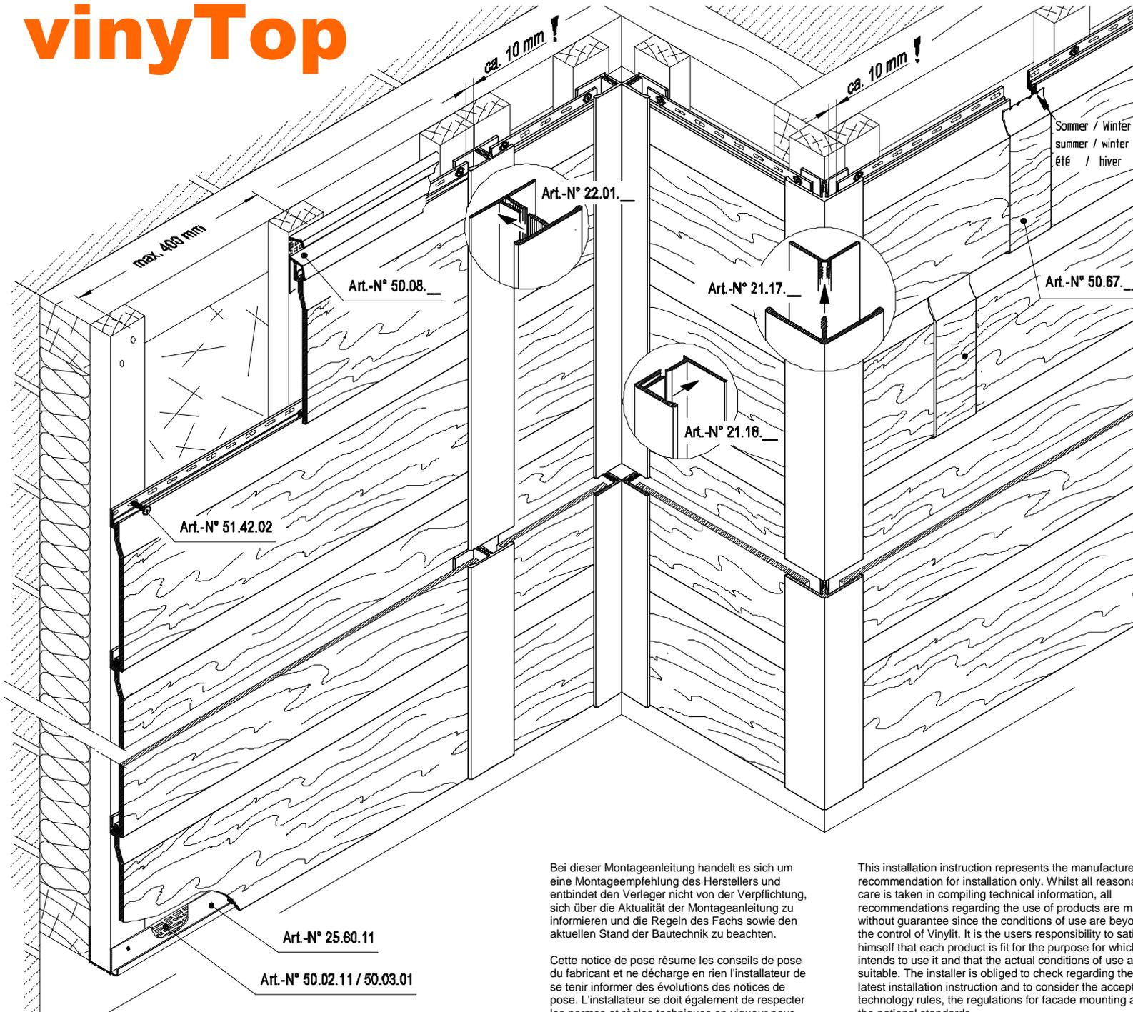
Bei dieser Montageanleitung handelt es sich um eine Montageempfehlung des Herstellers und entbindet den Verleger nicht von der Verpflichtung, sich über die Aktualität der Montageanleitung zu informieren und die Regeln des Fachs sowie den aktuellen Stand der Bautechnik zu beachten.
