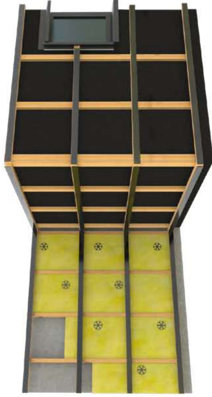
Konstruktion ohne Fassadenbahn
